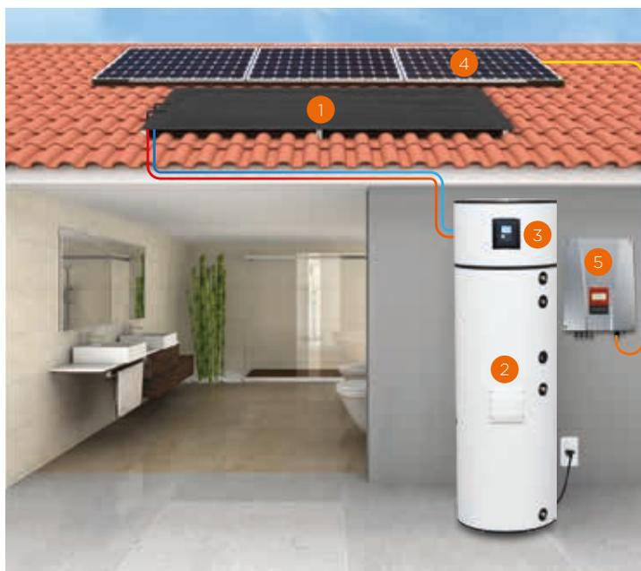
1. Painel Solar Termodinâmico. 2. Termoacumulador.
