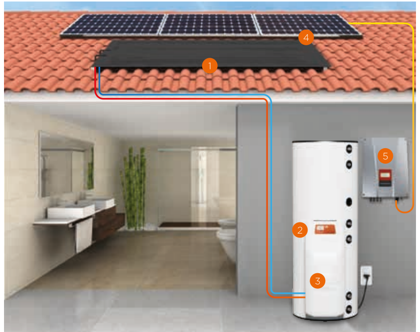
1. Pannello Solare Termodinamico. 2. Scaldabagno. 3. Blocco Termodinamico. 4. Pannelli Fotovoltaici. 5. Invertitore
