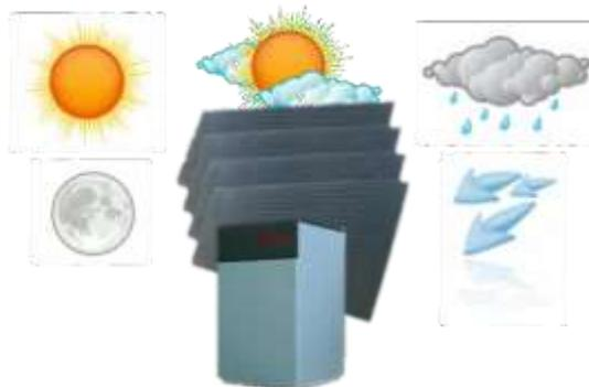
La differenza di temperatura provocata dai fattori suddetti garantisce che il fluido passi allo stato di vapore nell'interno del pannello.
