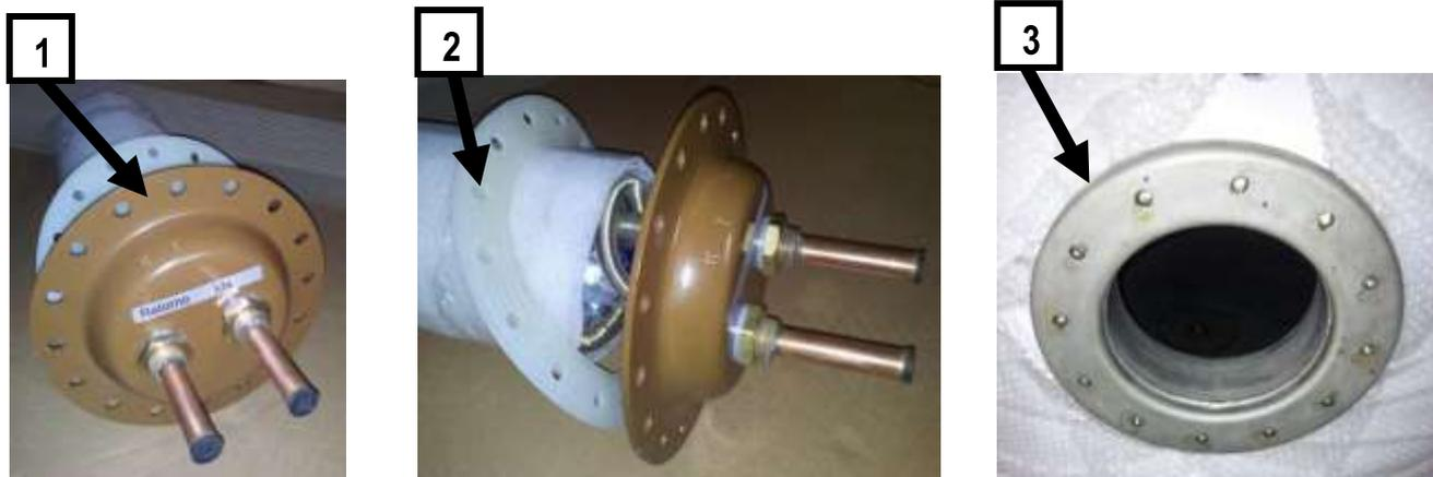
Lo scambiatore di calore per acqua calda sanitaria dovrà essere installato procedendo come di seguito indicato:
