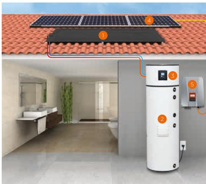
1. Panel Solar Termodinámico. 2. Termoacumulador.
