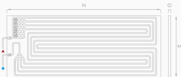
▲ Circuito del Vapore ● Circuito del Liquido
