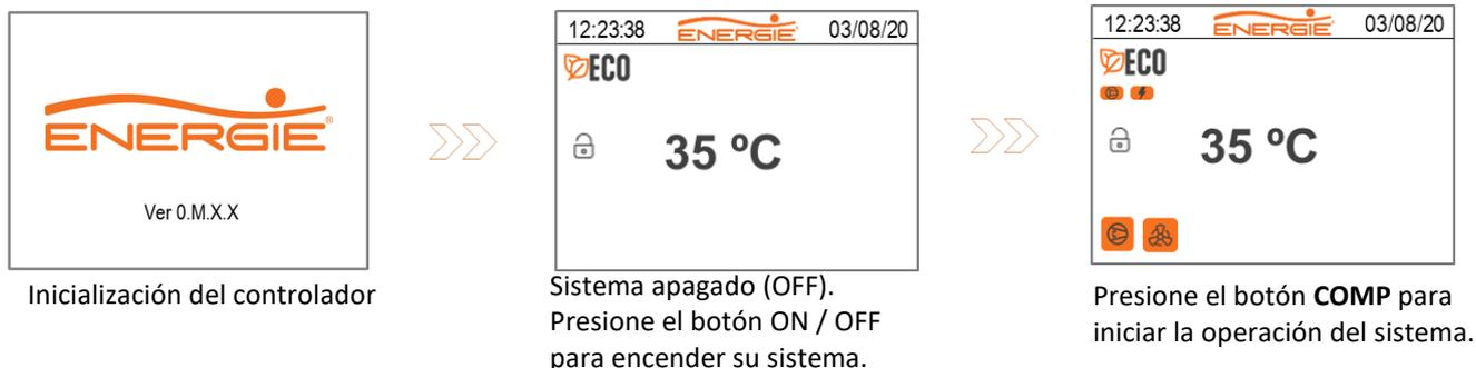
**Nota 1:** El led en el panel de control indica el estado de su equipo, si está parpadeando significa que el equipo no tiene orden de operación. Si la luz está fija, el equipo está operando en uno de los modos disponibles.
