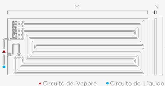
Impianto: Pannello Solare Termodinamico
